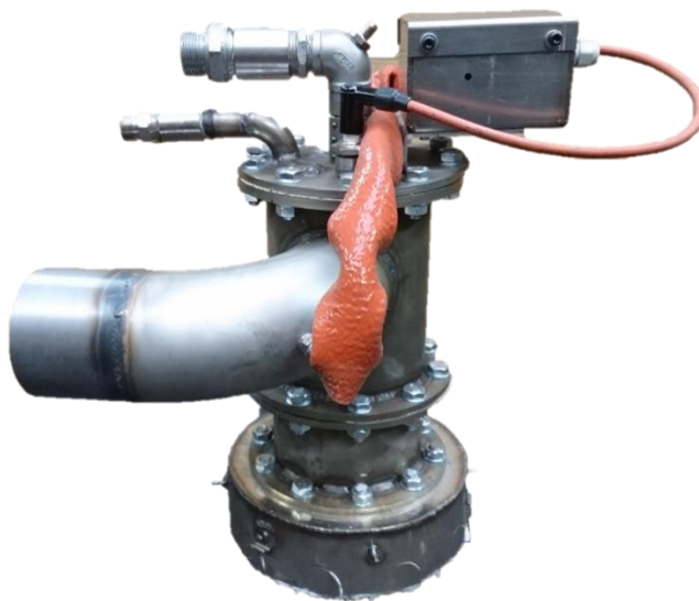
1. Palnik gazowy powietrzno-tlenowy, z zabudowanym transformatorem zapłonowym. Oraz pokrywą do mocowania w otworze w pokrywie kadzi.
